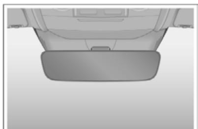
O espelho retrovisor interno automático deste veículo é equipado com sistema antirreflexo eletrônico, que pode ajustar a cor do espelho retrovisor interno dependendo do ambiente do veículo, para reduzir o incômodo do ofuscamento no campo visual traseiro do motorista.
