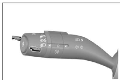
Gire o botão na extremidade do interruptor de farol para a posição “
