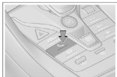
O motorista pode ligar ou desligar o sistema de monitoramento de ponto cego através do interruptor físico\* ou da interface de configuração Multimídia (Multimídia) → Dipilot. Quando o veículo é ligado, o sistema retorna à configuração feita pela última vez.
