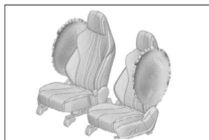
Se o veículo estiver equipado com airbags de cortina laterais nos bancos dianteiros esquerdo e direito (conforme mostrado na figura, os airbags estão posicionados fora do encosto de cada banco dianteiro e ambos estão marcados com AIRBAG):
