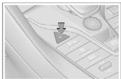
Ao pressionar o botão todos os sinalizadores de direção começarão a piscar e o indicador de sinalizador de direção do quadro de instrumentos piscará sincronizadamente.
