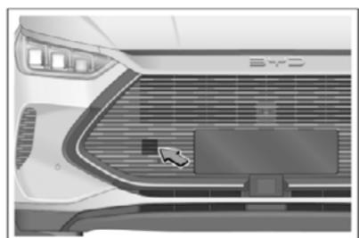
A posição de instalação do gancho de reboque frontal do veículo é mostrada na figura.
