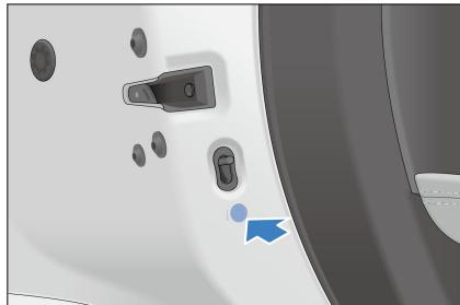
Das Etikett für die Heckklappenöffnung ist über dem Öffnungsschalter auf der rechten Seite der Heckklappe angebracht.
