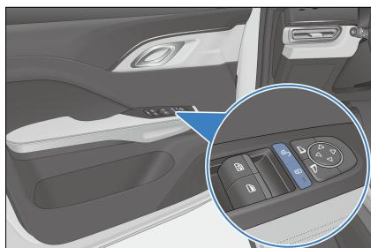
Drücken Sie die zentrale Entriegelungstaste, um alle Türen zu entriegeln. Sobald die Türen entriegelt sind, erlischt die Tastenanzeige.
