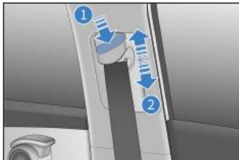
5. 調整完畢後，用力拉一下肩部安全帶，檢查安全帶高度調節器是否鎖止。
