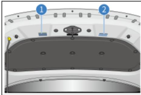
側安全氣囊警告標籤貼在左右 B 柱鎖環下方。
